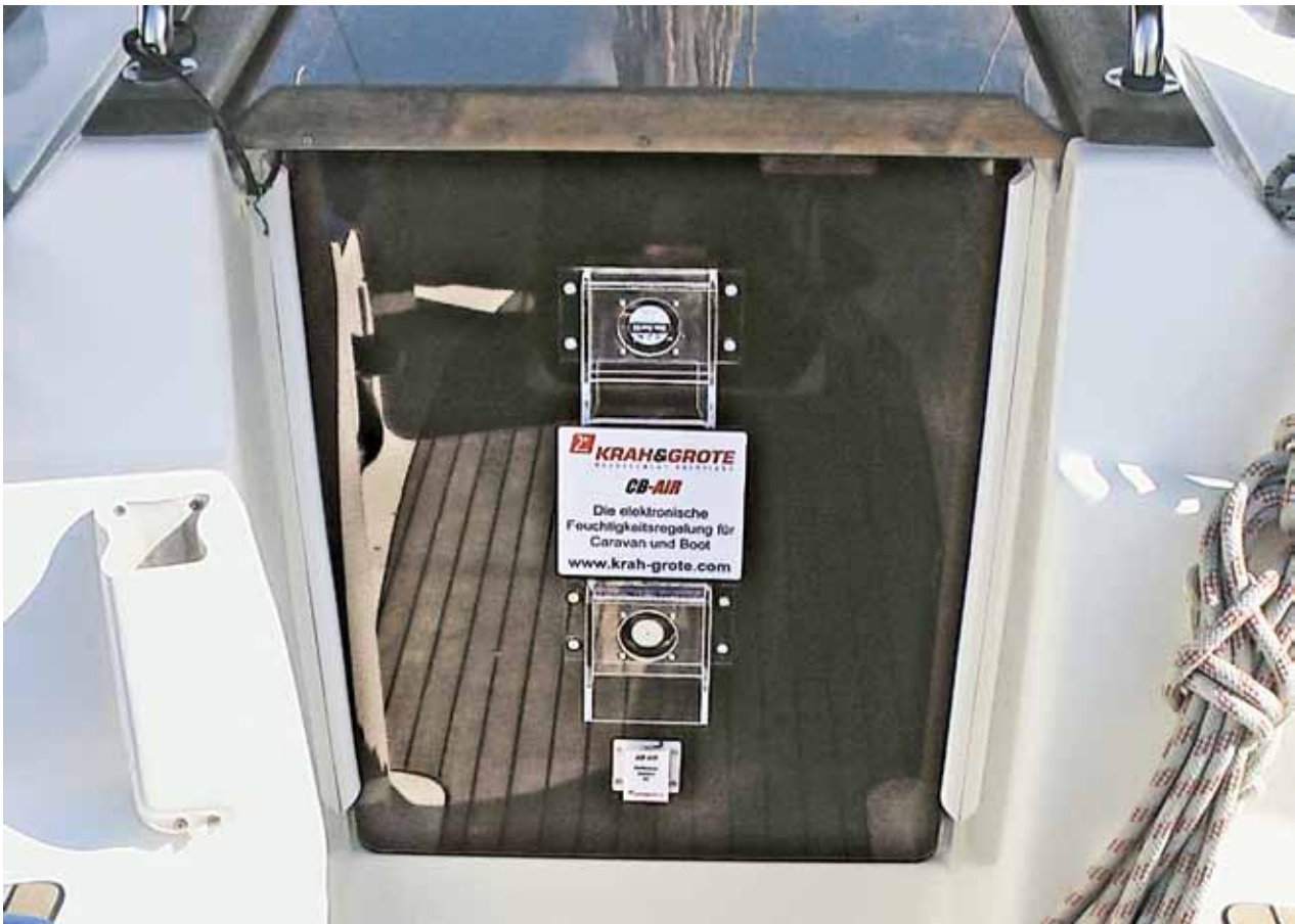
Zu- und Ablüfter der Anlage sind hier im Steckschott montiert.
