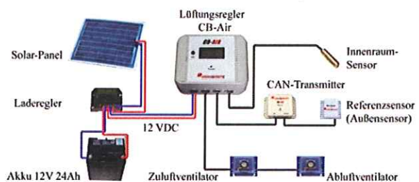
Anschluss - Schema: CB-Air an Solarpanel und Akku
