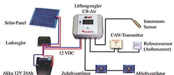
Anschluss - Schema: CB-Air an Solarpanel und Akku
